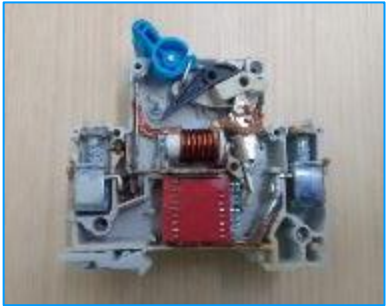
Disjuntor ELGIN (Sem oxidação após teste de Salt-Spray)
